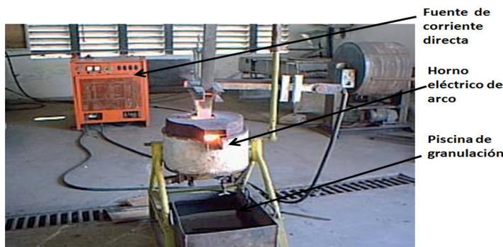
Fig. 2. Equipamiento para el procesamiento pirometalúrgico carbotérmico.
