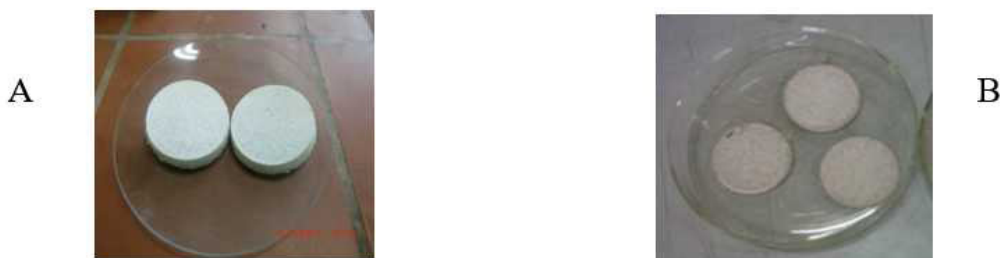
Fig. 1. Membranas cerámicas sintetizadas con materiales de desecho o producto natural. A) Membranas vítreas, B) Membranas de zeolita natural
