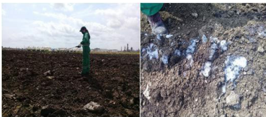
Fig. 3. Biorremediación de suelos contaminados con petróleo en la refinería Níco López aplicando bioestimulación con ramnolípidos Y3-B1A. Fuente: Barrios Y y Toledo H
